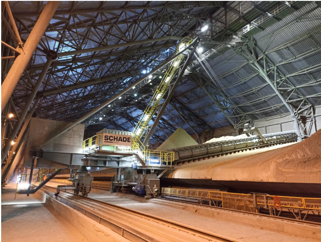
01 Maßarbeit: SCHADE Seitenkratzer mit Bandförderanlage nach 10 Tagen in Betrieb
